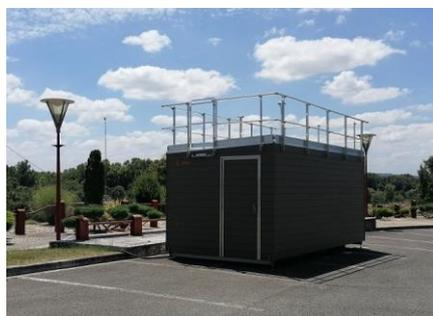
Figure 1 : Exemple de station de mesure de la qualité de l'air
