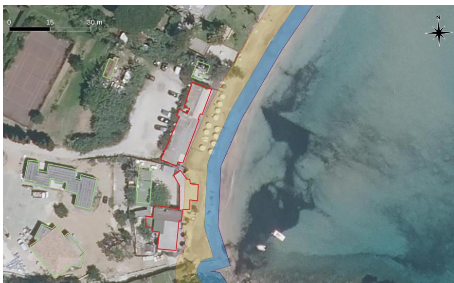
Figure 4 : Le bâtiment en rouge et situé au nord a été considéré comme potentiellement menacé à 5 ans en raison de sa proximité avec le tampon de recul et pour assurer la cohérence avec le bâtiment situé plus au sud (fond de plan : Bd-Ortho IGN)
